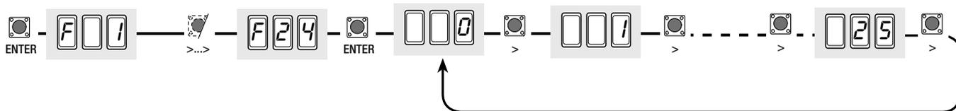
**F 25 (Temps lampe de courtoisie) :** lampe supplémentaire raccordée sur (10-E), elle reste allumée pendant le temps nécessaire au cours des manœuvres d'ouverture/fermeture du portail.
