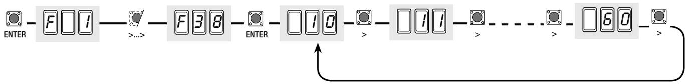
**F 39 (Point de déplacement ouverture du moteur M1)** : elle règle le point de début du déplacement du moteur (M1) avant le fin de course d'ouverture. Le point de début du déplacement est calculé en pourcentage sur la course complète du vantail. (voir par. illustration des zones et des points de ralentissement et de déplacement)
