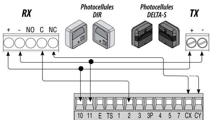
Configurez le contact CX ou CY (N.C.), entrée pour dispositifs de sécurité type bords sensibles conformes à la norme EN 12978.
