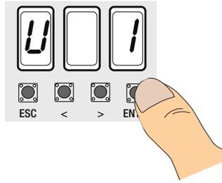
2) Choisissez la commande (1= pas-à-pas, 2= séquentielle, 3=ouverture, 4=ouverture pour piétons/partielle, 5=sortie contact B1-B2) à associer à l'utilisateur en utilisant les flèches. Appuyez sur ENTER pour confirmer. ...
