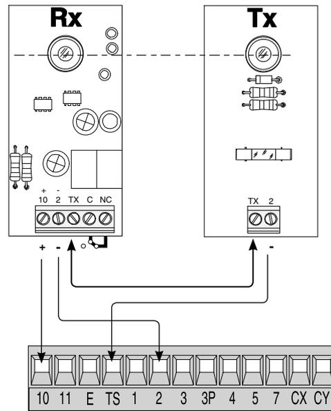
A chaque commande d'ouverture ou de fermeture, la carte contrôle l'état de fonctionnement des dispositifs de sécurité (photocellules). Une anomalie éventuelle des photocellules est signalée sur la carte électronique et elle annule n'importe quelle commande de l'émetteur radio ou du bouton.
