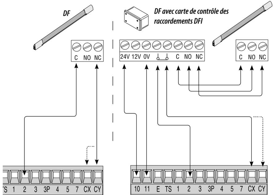
**Raccordement électrique pour le fonctionnement du test de sécurité des photocellules**
