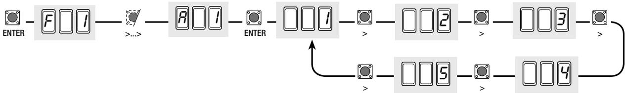
**A 2 (Test moteurs) :** activation du test pour vérifier si le sens de rotation des motoréducteurs est correct (voir paragraphe "test moteurs")
