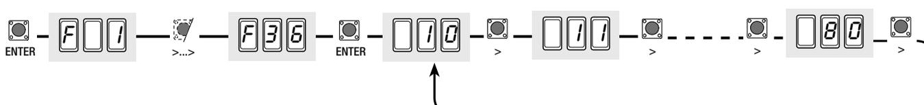
**F 37 (Point de ralentissement ouverture du moteur M1)** : elle règle le point de début du ralentissement du moteur (M1) avant le fin de course d'ouverture. Le point de début du ralentissement est calculé en pourcentage sur la course complète du vantail (voir par. illustration des zones et des points de ralentissement et de déplacement)
