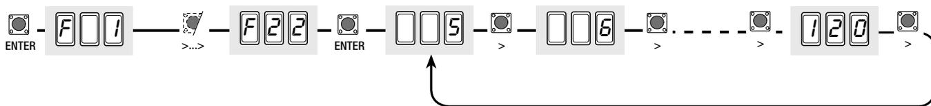
**F 23 (Temps de retard en ouverture) :** après une commande d'ouverture, le vantail du motoréducteur (M1) part en retard par rapport au motoréducteur (M2) pendant un temps réglable.
