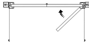
5) ... successivement le vantail du deuxième moteur, effectuera une manœuvre d'ouverture jusqu'à la butée d'arrêt...
