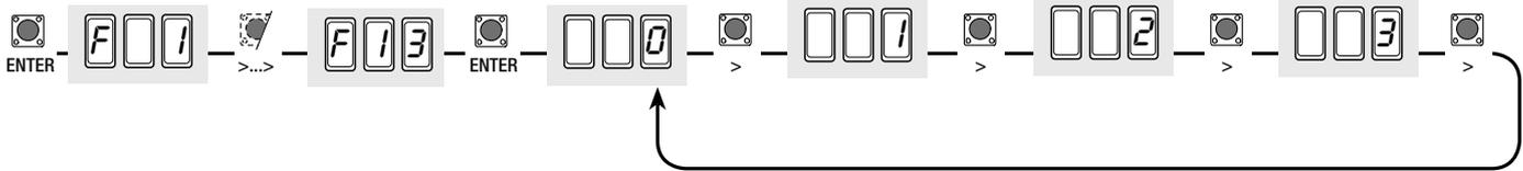
**F 14 (Type de capteur) :** configuration du type de capteur pour la commande de l'automatisme par transpondeur (TSP00) ou Lecteur de cartes magnétiques (LT001) avec carte de décodage R700 ou bien avec clavier à code S7000 avec carte de décodage R800.
