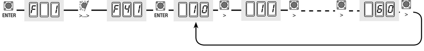
**F 42 (Point de ralentissement fermeture du moteur M2)** : elle règle le point de début du ralentissement du moteur (M2) avant le fin de course de fermeture. Le point de début du ralentissement est calculé en pourcentage sur la course complète du vantail. (voir par. illustration des zones et des points de ralentissement et de déplacement)
